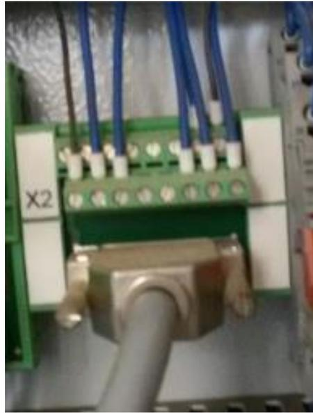
**Figure I.2 Terminal d'entrées/sorties analogiques X2**
