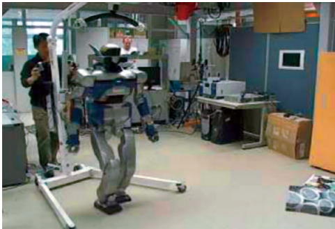
FIGURE 1.1: Robot HRP-2 qui marche d'une manière autonome en utilisant MonoSLAM
