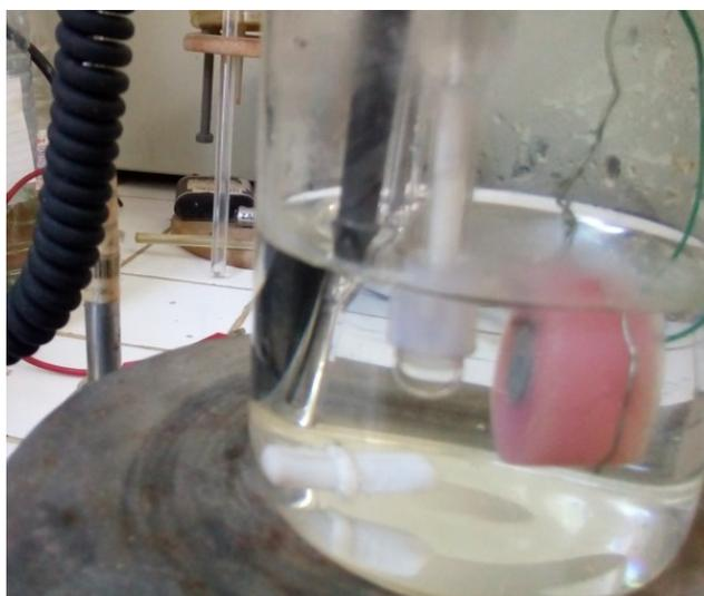
FIGURE 8.18 – la surface d'échantillon en parallèle avec l'électrode de référence.
