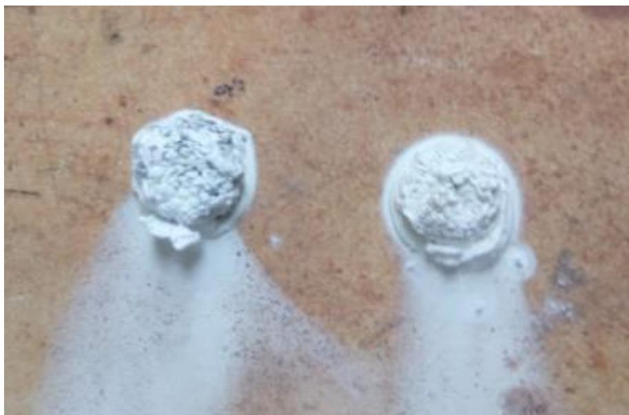
FIGURE 8.11 – formation d'une couche d'oxyde.
