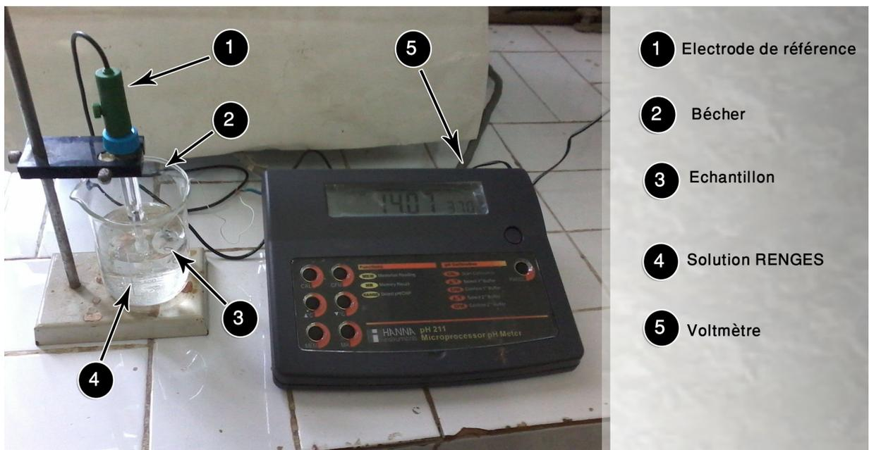
FIGURE 8.16 – Mesure de potentiel libre d'échantillon avec la solution Ringer's.
