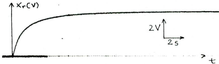
Fig 1.6.4.1 Effet de l'inertie sur la réponse en vitesse
