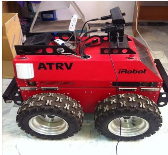
**Figure I.8 :** Robot mobile ATRV2 pour des terrains plats [22].
