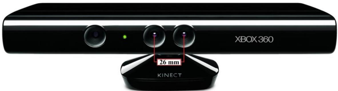
Figure I.19 : Distance entre caméra RGB et caméra IR.
