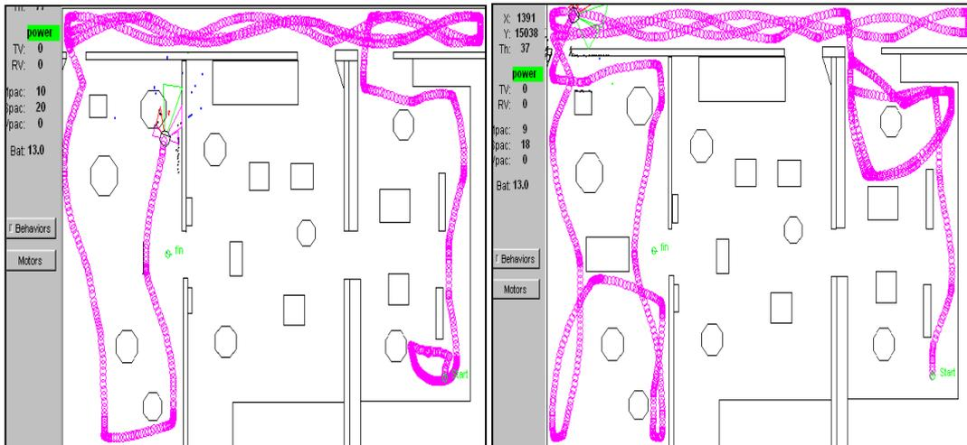
**Figure III.12 :** Trajectoires du robot pendant et après apprentissage dans un environnement plus encombrés.
