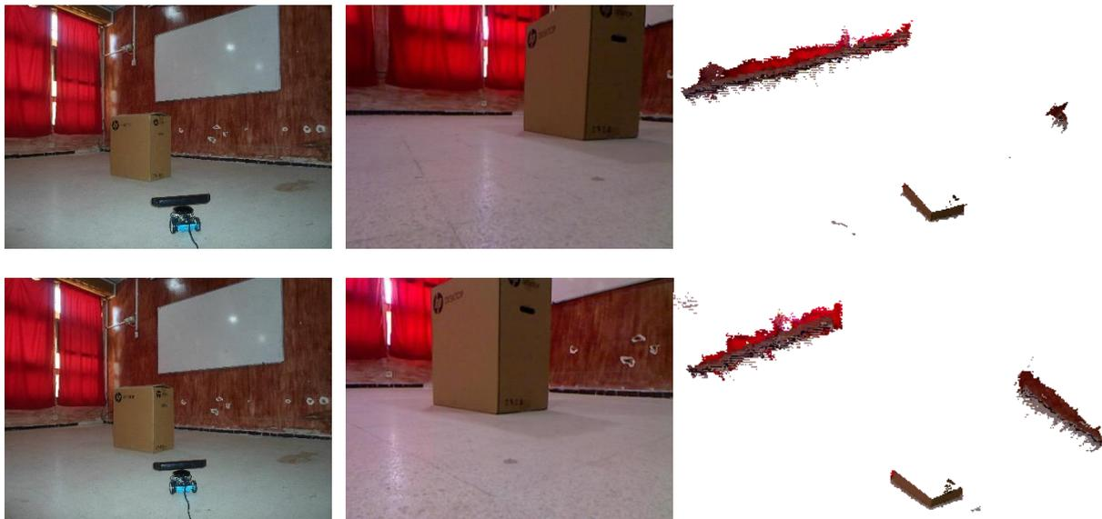
**Figure IV.23 (a) :** Les différentes phases de la reconstruction 3D de la salle avec obstacle.
