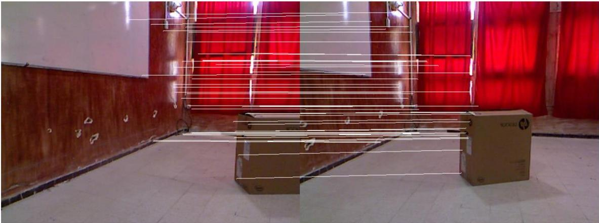
**Figure IV.6 :** Élimination des fausses correspondances avec le RANSAC.
