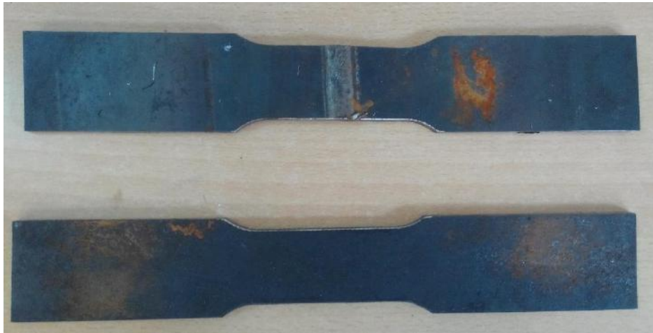
Figure III.6: Eprouvettes de traction dans la soudure et le métal de base.
