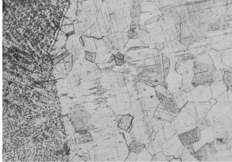
Figure 0.2 Microstructure de la zone de liaison (x200)
