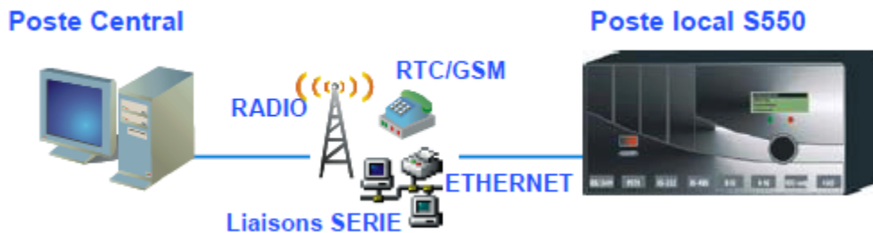
FIGURE 1.3: Communications avec un Poste Central
