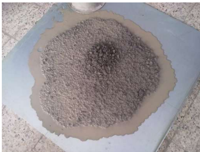
Figure IV.4 : Cas d'un mauvais béton autoplaçant.
