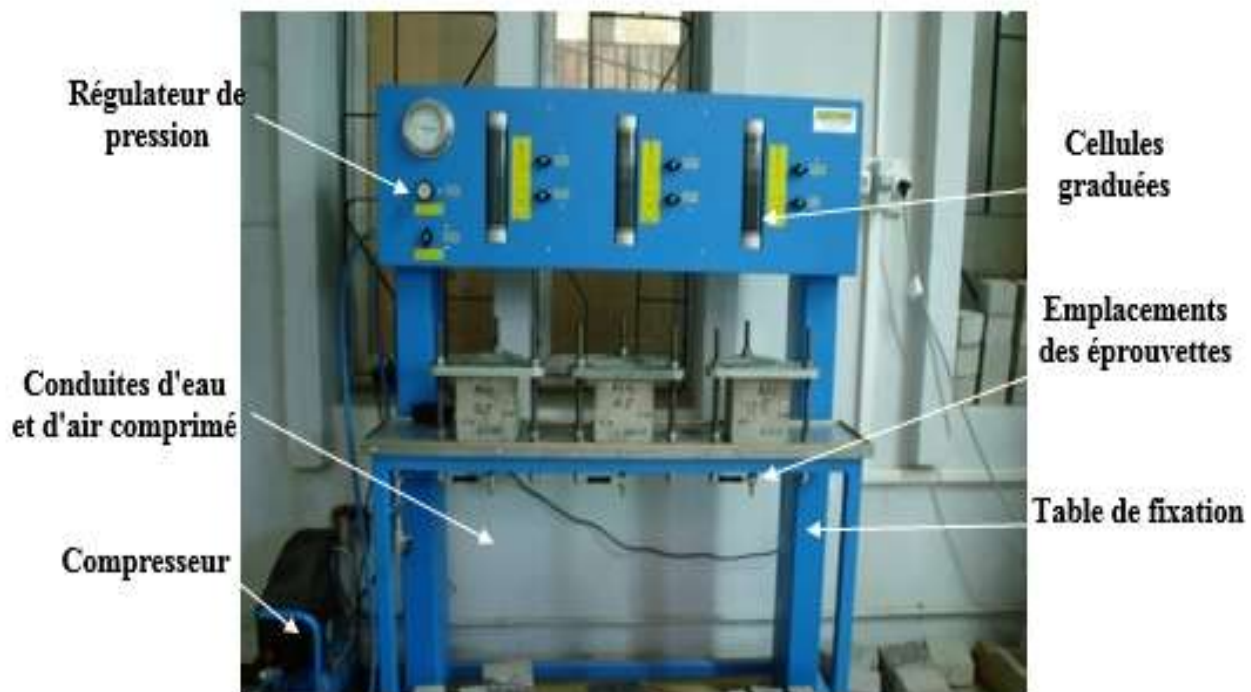
Figure IV.11 : Dispositif pour l'essai de perméabilité de béton à l'eau.
