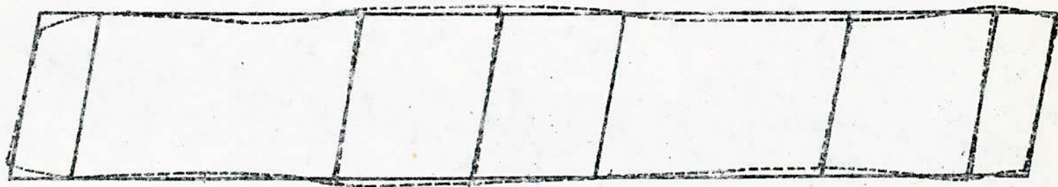
Fig(4.2): Tracé de l'allure des déformées modales du chassis chargé correspondante au 1 er mode
