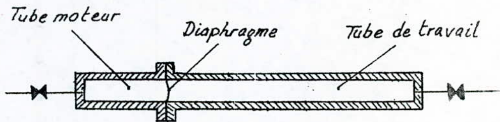
figure I.2.1 Tube à choc simple à section constante
