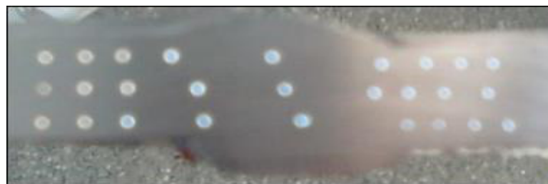
Figure V.5. Eprouvette de l'essai de dureté.
