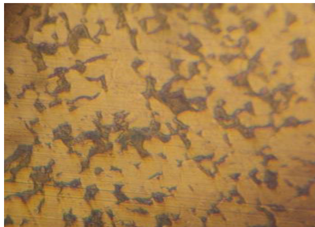
Figure II.3. Microstructure des échantillons de l'acier API 5L X60M étudié.
