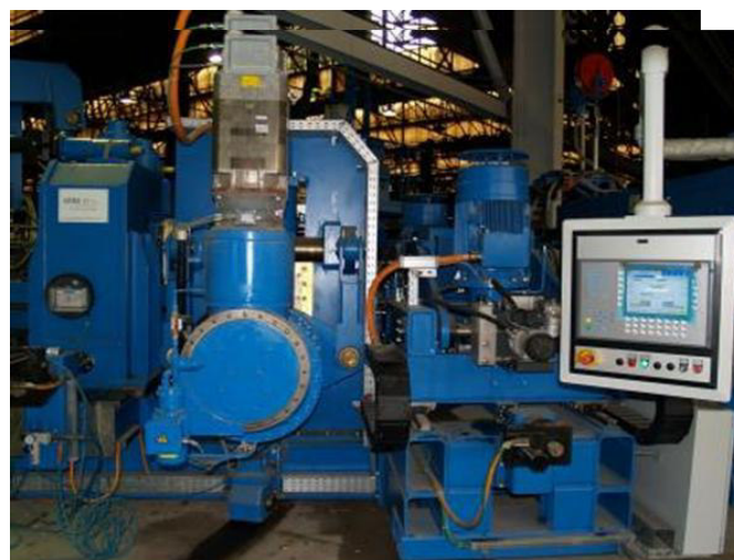
Figure III.7. Machine ATIS pour le soudage SAW H.
