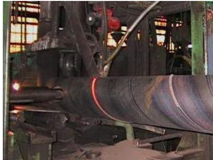
Figure III.9. Réalisation d'une soudure spirale sur tube API.
