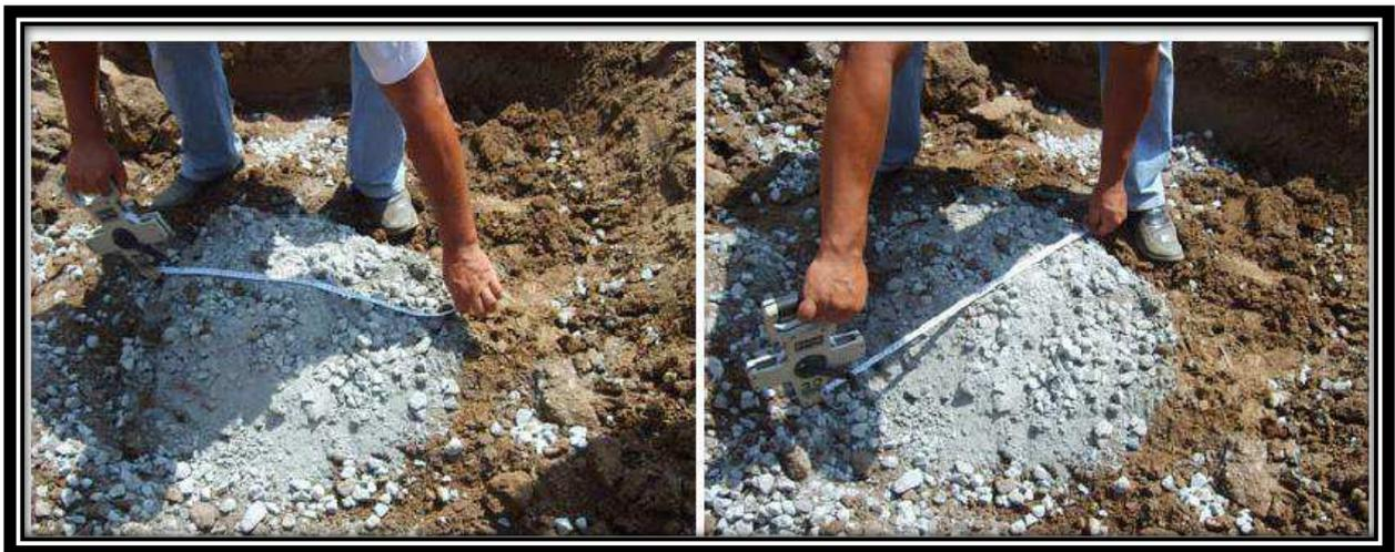
Figure VI.3 : Mesure des deux dimensions (L et 2R) d'une colonne après son dégarnissage
