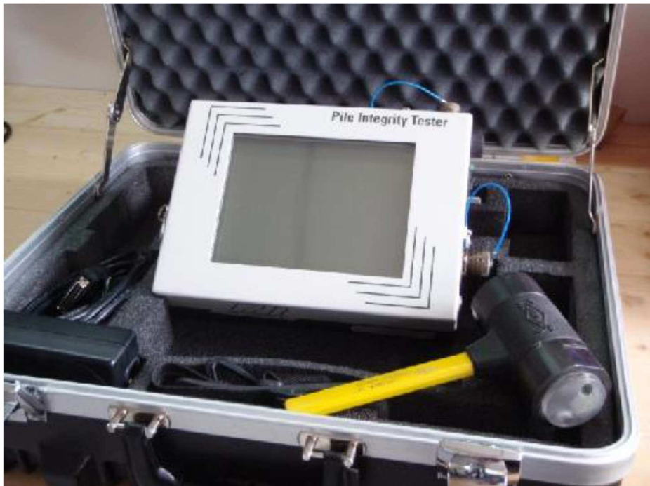
Figure V.5 : Analyseur : PIT (Pile Integrity Tester N° série : 3625C)
