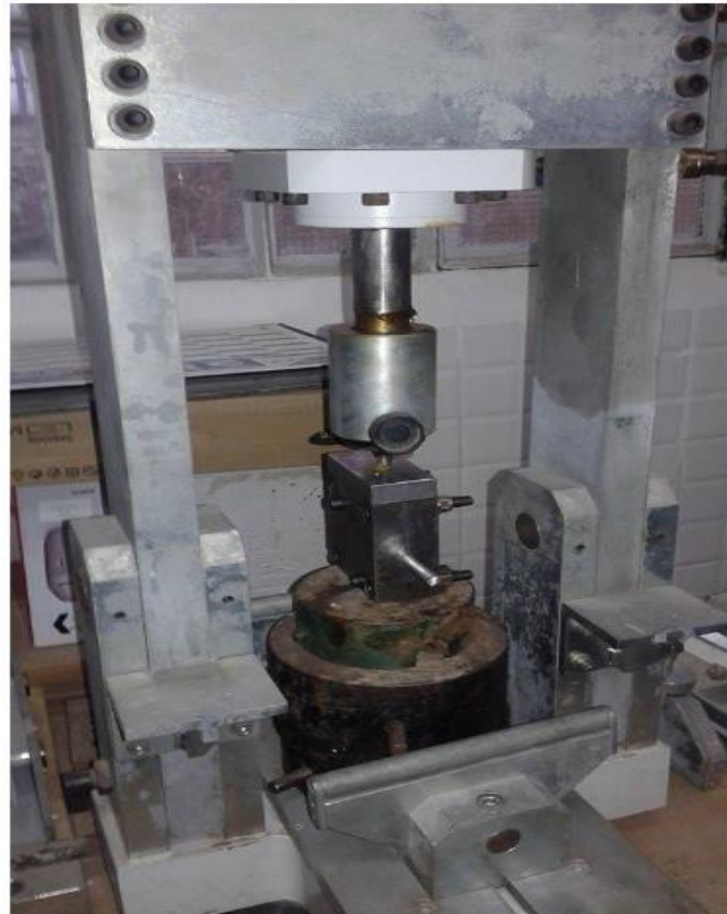
Figure 2.1.8 : Image prise lors d'un test ECAP (LGSDS).
