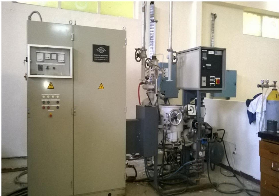
Figure 2.1.1: Vue global du four de fusion à induction LEYBOLD-ISO1 (CRND).
