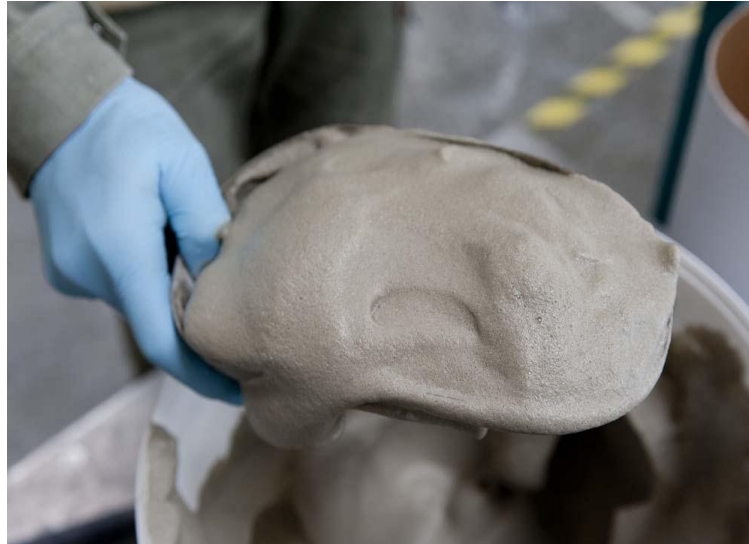
Figure IV-3 Coulis à base de ciment.
