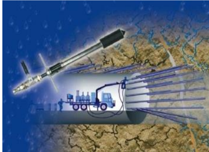
Figure IV-2 Principe de la réparation par injection.
