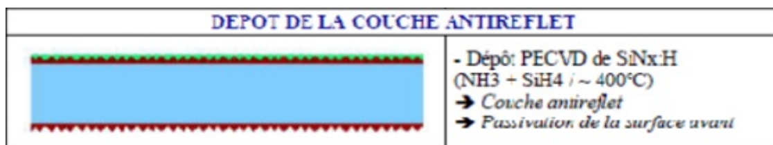
FIGURE 1.10: Schéma d'une cellule photovoltaïque avec une CAR.
