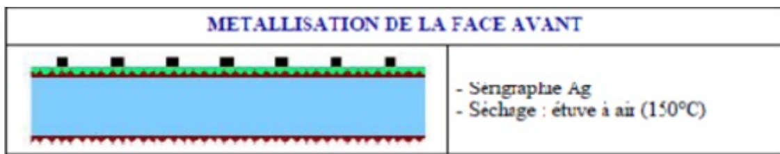
FIGURE 1.11: Schéma d'une cellule photovoltaïque avec face avant métallisée.
