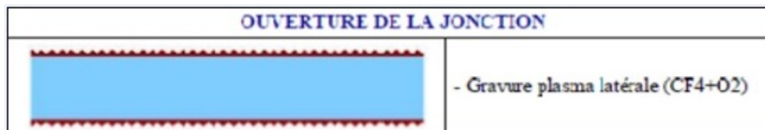
FIGURE 1.9: Schéma d'une cellule photovoltaïque aux jonctions ouvertes.
