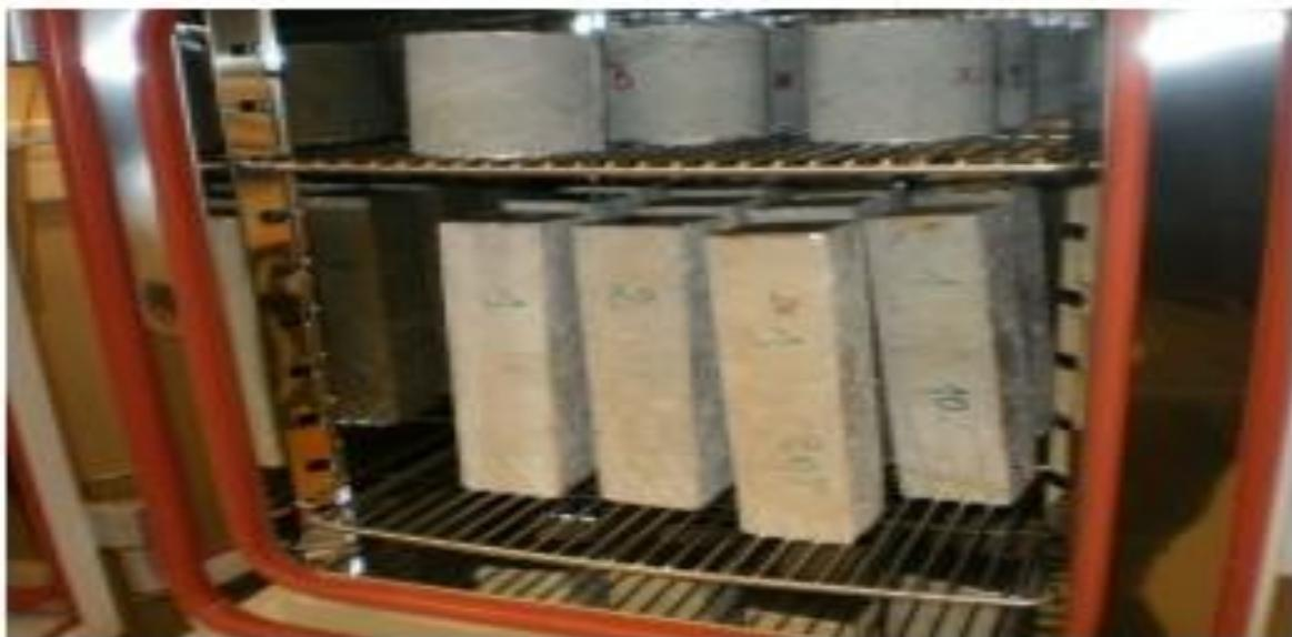
**Figure 4.2:** Enceinte climatique assurant l'homogénéisation (29)
