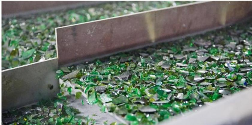
**Figure 1.3:** Le verre concassé dans une machine de recyclage
