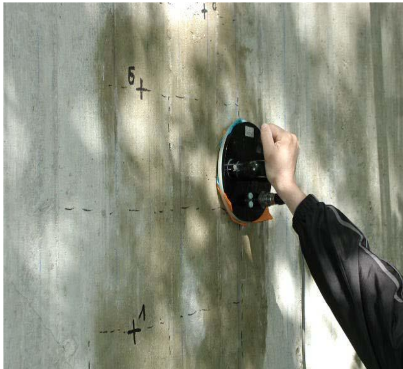
Figure II.4: Mesure de la vitesse de corrosion.
