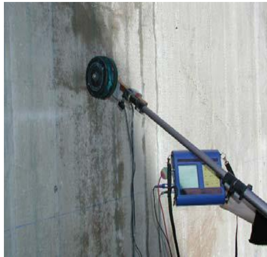
Figure II.3: Mesures de potentiel.
