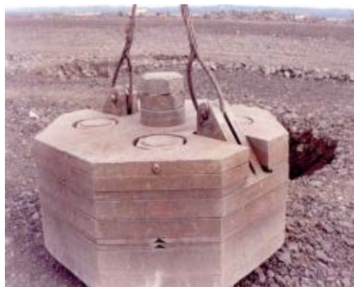
Figure 2 - 6 : Exemple d'un pilon utilisé dans le compactage dynamique.
