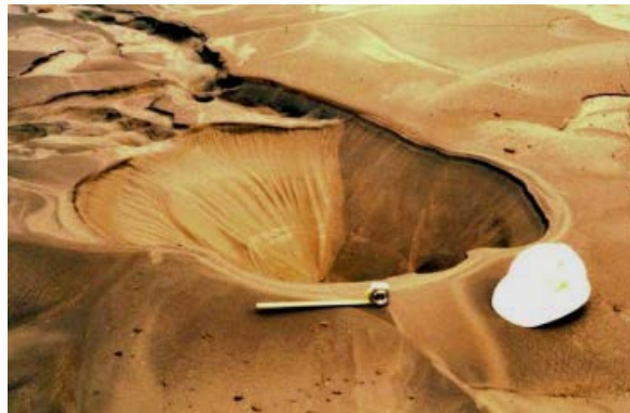
Figure 1 - 10 : Ebullition de sable à l'aéroport d'Oakland, le long du fleuve de Salina et à la station marine de Moss Landing (D'après Robert E. Kayen et al, 1998).
