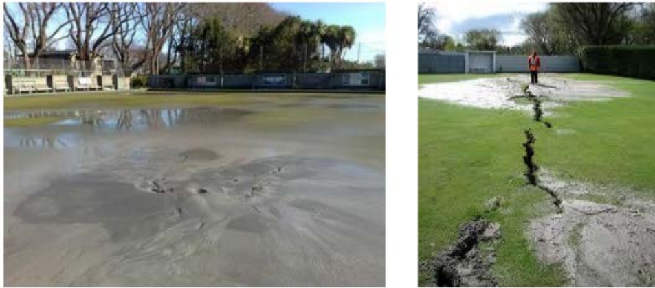
Figure 1 - 20 : Ebullitions de sable dues à la liquéfaction, après le tremblement de terre à Christchurch, New Zealand (2011).
