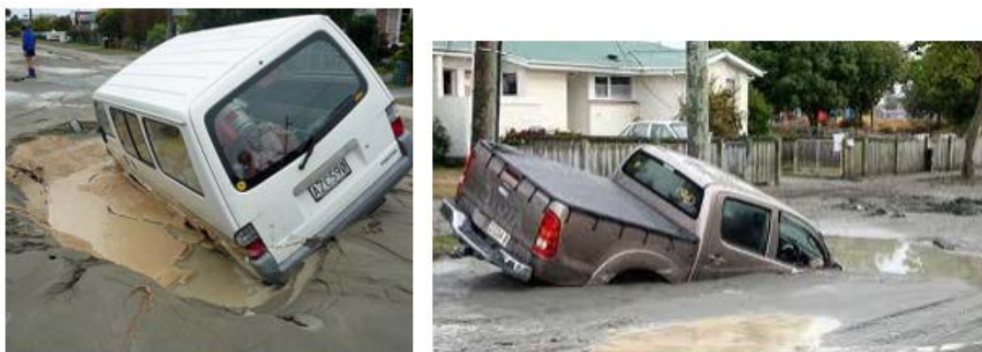
Figure 1 - 19 : Véhicule enlisé dans la liquéfaction, après le tremblement de terre à Christchurch, New Zealand (2011).
