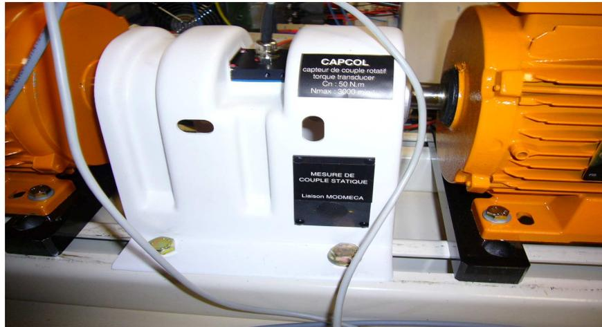
Fig.B.6. Photo capteur de couple
