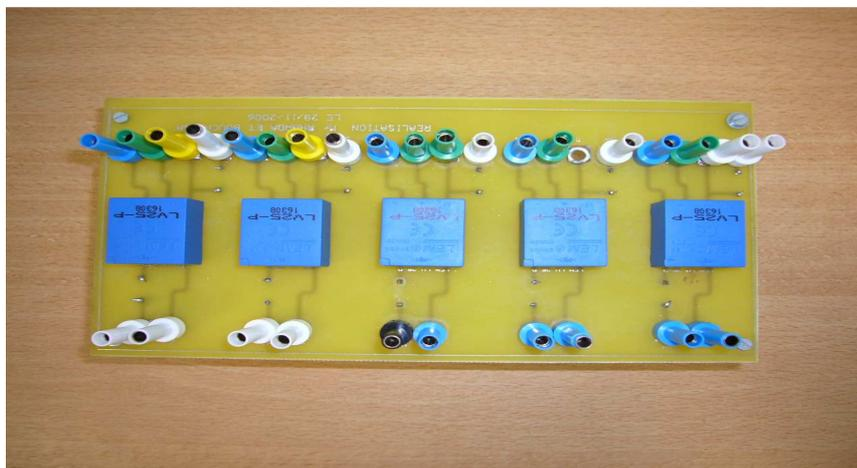
Fig.B.8. Carte de mesure des tensions
