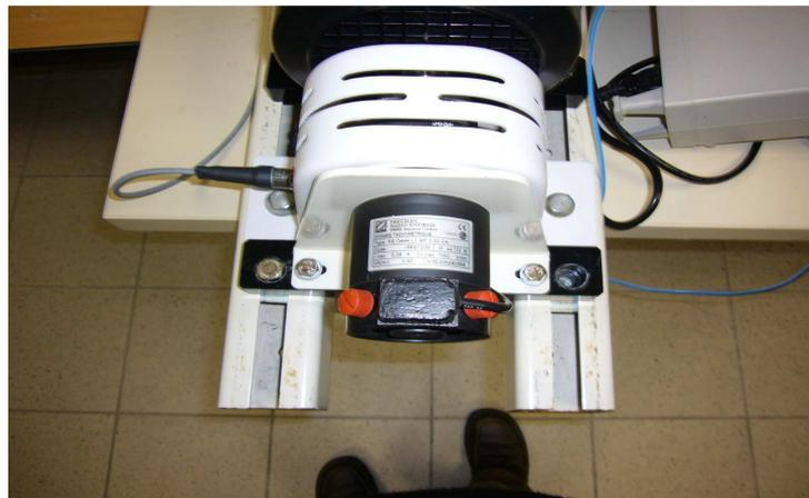
Fig B.7. Photo capteur de vitesse
