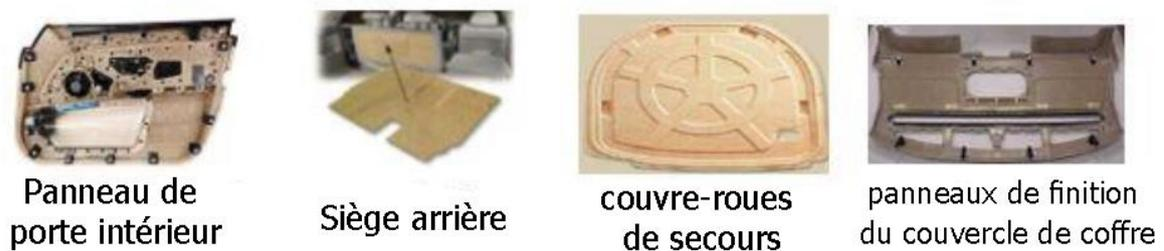
**Figure 1.16 : Composants intérieurs d'une voiture fabriqués à partir de composites à base de fibres naturelles [50].**
