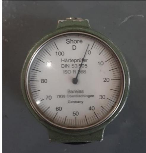
**Figure 2.9 : Duromètre Shore D.**
