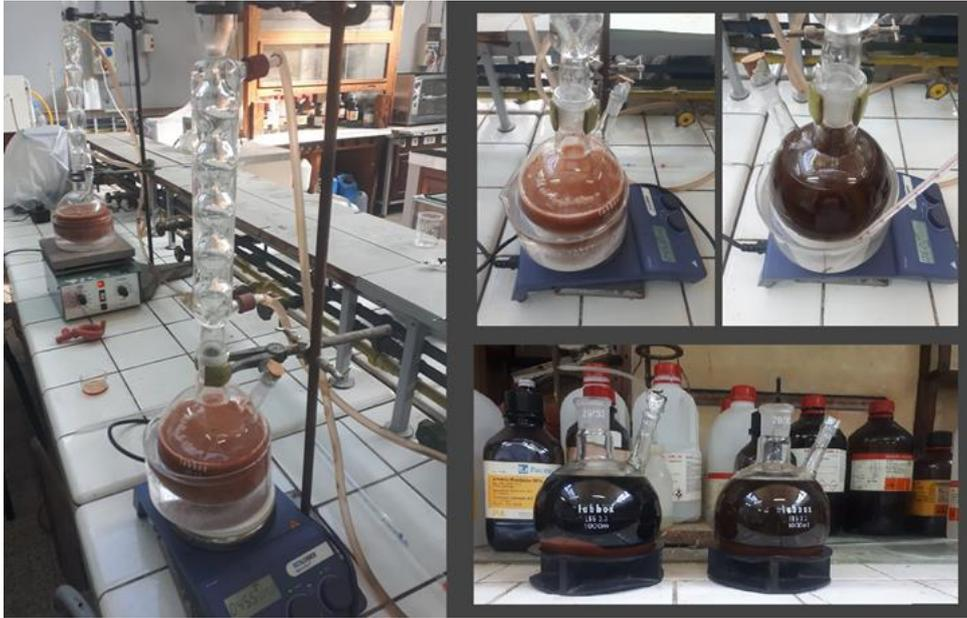
Figure 2.3 : Installation du traitement chimique de la FND.
