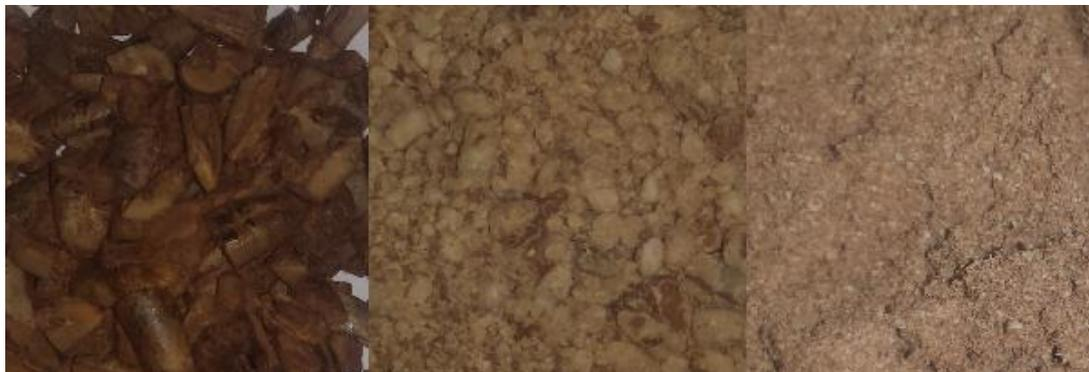
Figure 2.1 : Etapes du broyage des noyaux de dattes.
