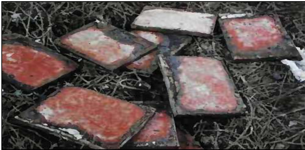
Figure II.3 : corrosion des frettes en acier.
