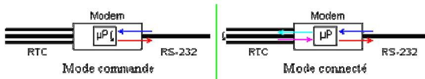
Figure II.3 : Mode commande, mode connecté
