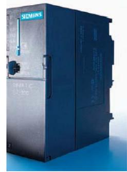
L'automate permettra de programmer les données à récolter et à transmettre. Il permet aussi de programmer les conditions de ces échanges de données, de commander l'établissement ou l'arrêt de la communication, de choisir la configuration Maître ou Esclave et l'esclave avec lequel l'on veut communiquer, et plusieurs autres options que l'on verra à la partie pratique de ce mémoire. Il permet surtout de se connecter sur la plupart des réseaux de terrain, comme le montre la **figure** suivante :
