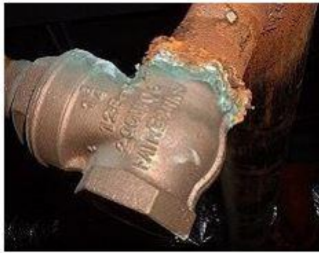
Figure I-3 : Exemple et schéma explicatif de la corrosion galvanique.
