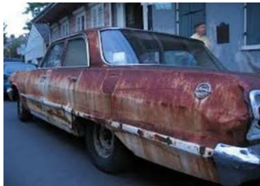
Figure I-2 : Exemple de corrosion généralisée.
