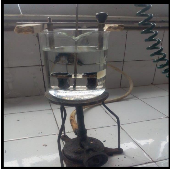
Figure .4.2. Essai Bille-Anneau
