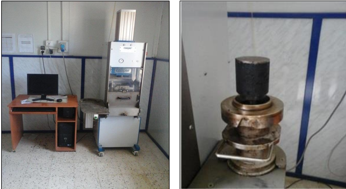
Figure 3.16. Presse à cisaillement Giratoire (PCG) [86].
