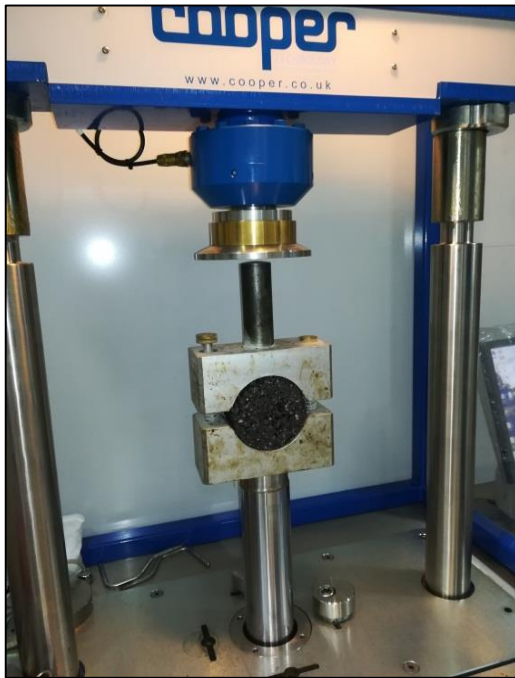
Figure 3.15 : Damme et presse Marshall [85].
