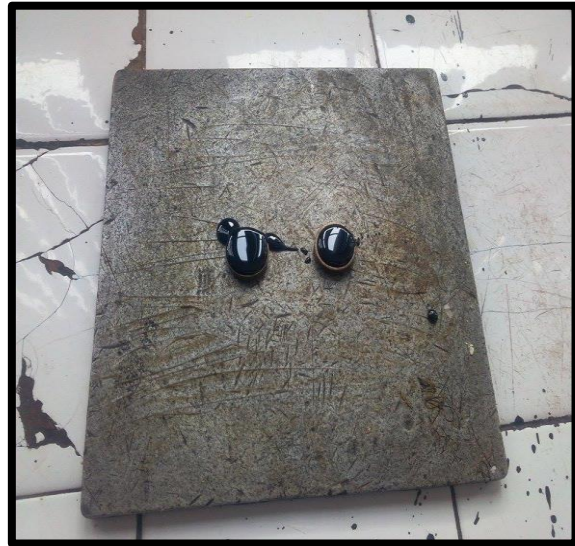
Figure .4.2. Essai Bille-Anneau
