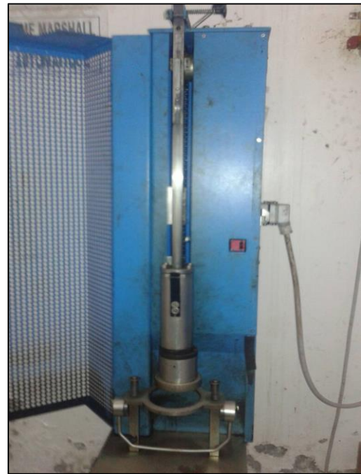
Figure 3.15 : Damme et presse Marshall [85].
