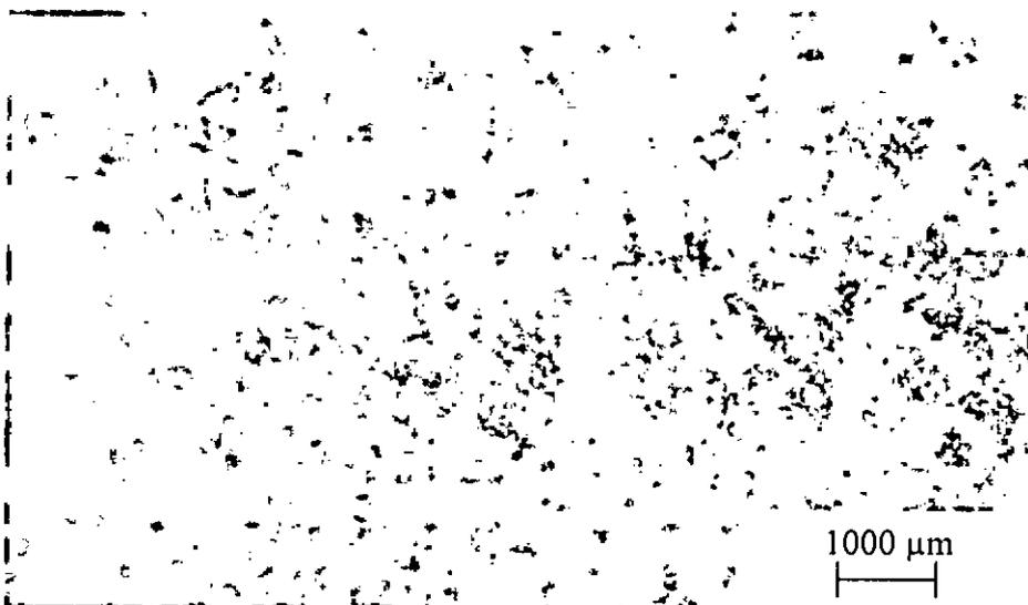
**Figure V-12:** Etat de surface du X52 après une corrosion de 1 heures et 30 minutes.
