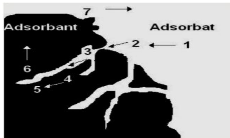
Figure 2.1 : Étapes du processus d'adsorption/désorption sur un matériau poreux.
