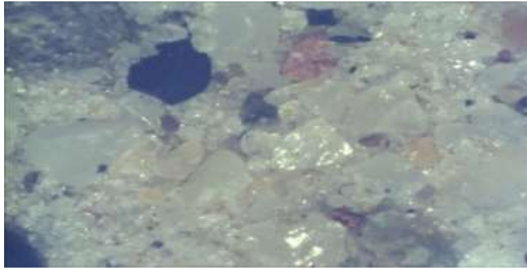
Figure C.2. Micrographie optique montrant la forme et la taille des particules obtenues après 10 cycles de désintégration : G = 16x
