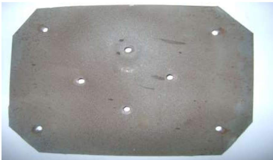
Figure B.7. Cible métallique en tôle d'acier doux d'épaisseur 1,5 mm.
