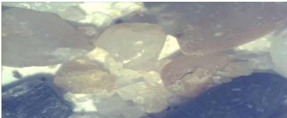
Figure C.7. Micrographie optique montrant la forme et la taille des particules obtenues après 5 cycles de désintégration : G = 20x
