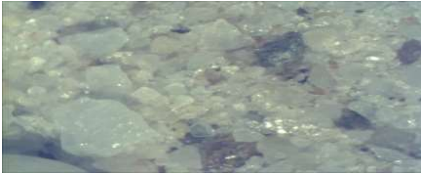
Figure C.5. Micrographie optique montrant la forme et la taille des particules obtenues après 10 cycles de désintégration: G = 16x
