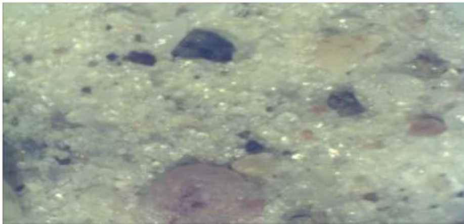
Figure C.9. Micrographie optique montrant la forme et la taille des particules obtenues après 14 cycles de désintégration : G = 16x
