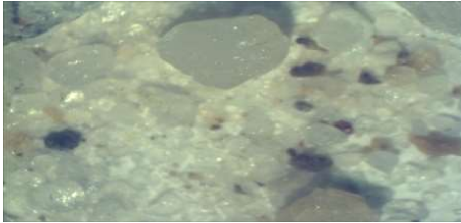
Figure C.8. Micrographie optique montrant la forme et la taille des particules obtenues après 10 cycles de désintégration : G = 16x
