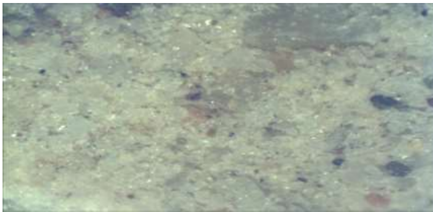
Figure C.6. Micrographie optique montrant la forme et la taille des particules obtenues après 14 cycles de désintégration : G = 16x
