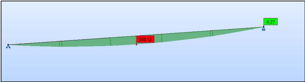
Diagramme du moment fléchissant en T.m sous l'effet de la combinaison ELU A 1v
