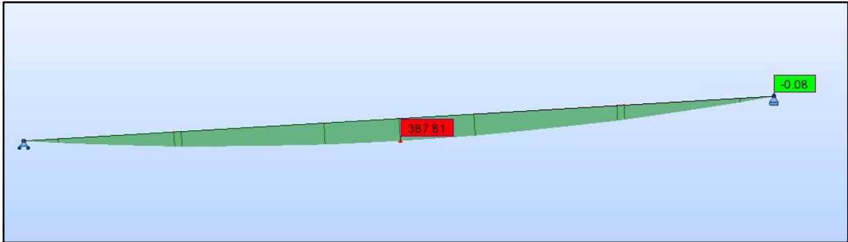
Diagramme du moment fléchissant en T.m sous l'effet de la combinaison ELU A 2v.
