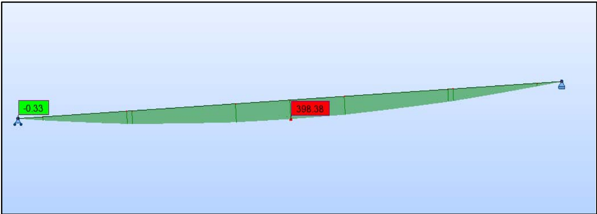
Diagramme du moment fléchissant en T.m sous l'effet de la combinaison ELU D240.
