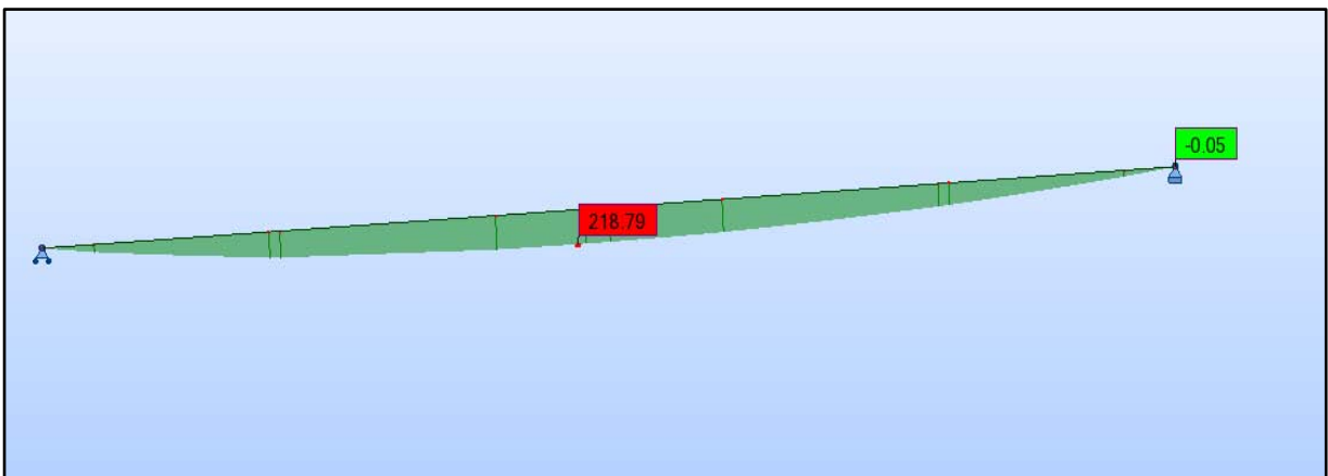
Diagramme du moment fléchissant en T.m sous l'effet de la combinaison ELS Mc 120.
