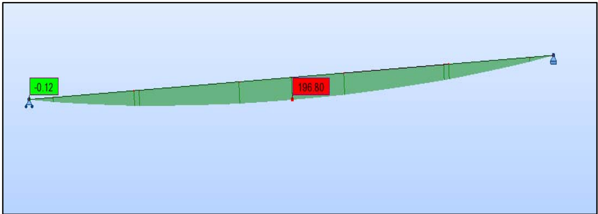
Diagramme du moment fléchissant en T.m sous l'effet de la combinaison ELS BC 1v.
