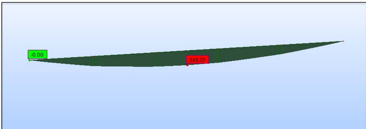
Figure 6.8 : Diagramme du moment fléchissant en t.m sous l'effet de la combinaison ELS D240.
