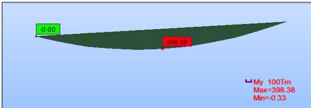
Figure 6.6 : Diagramme du moment fléchissant en t.m sous l'effet de la combinaison ELU D240.
