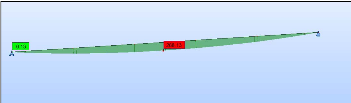
Diagramme du moment fléchissant en T.m sous l'effet de la combinaison ELU BC 2v.
