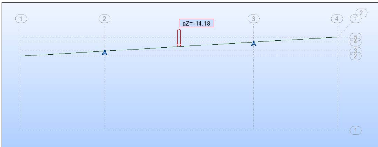
Figure 5.3 : Modélisation du clavage central
