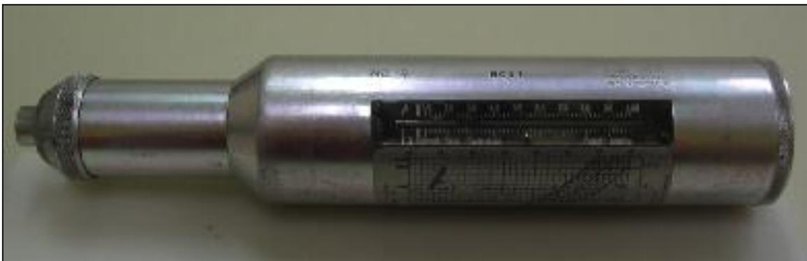
Fig.III.6. Essai au marteau Schmidt
