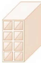
Fig 1- 9: Brique creuse
