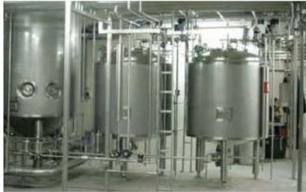
Figure 2.6 : Fermenteur expérimental de 3 m 3 (Université Wagening, 2009).
