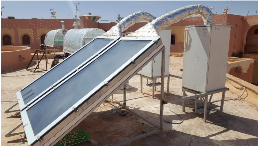
Figure 4.8 : Séchoir solaire indirect avec chicanes (BENSEDDIK non publié)
