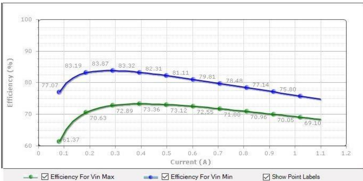
Figure III.13 : Rendement du convertisseur pour l'alimentation 1,1V
