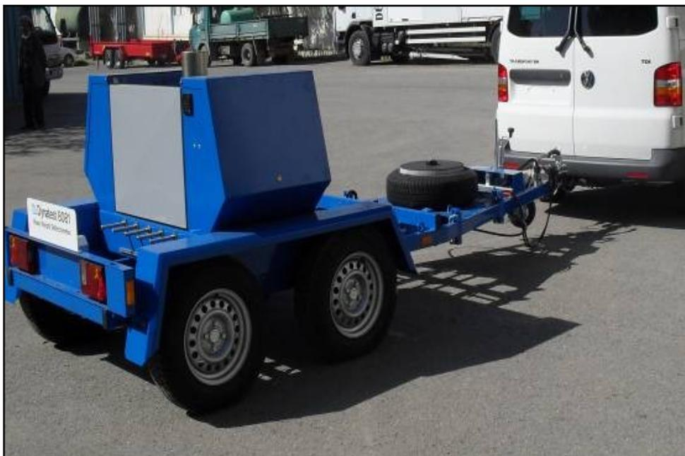
Figure II. 3 : L'appareil d'acquisition HWD du CTPP [3]
