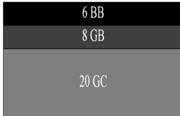
**Figure IV. 6 :Structure de dimensionnement par la méthode CBR**
