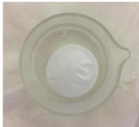
**Figure 5.6 : Suspension d'alginate après quelques heures de contact avec le calcium.**
