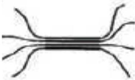
**Figure 1.4 : Structure microcristalline d'un gel de polyvinyle (Bounouira, 2015).**
