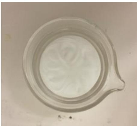
**Figure 5.5 : Suspension d'alginate au début du contact avec le calcium.**
