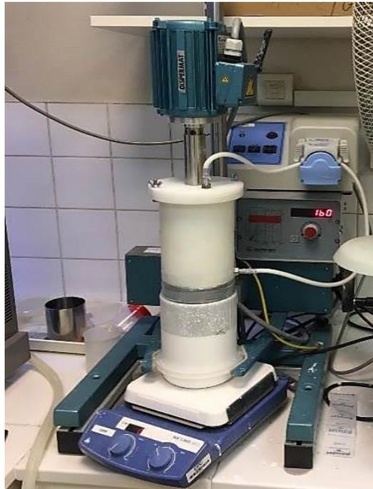
Figure 2.1 : Broyage des suspensions de zircone
