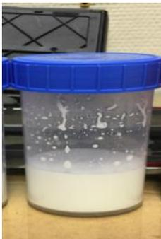
**Figure 5.2 : Suspension alginate/zircon.**
