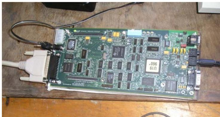
**Figure 3.28** : Carte DSK utilisée pour l'implémentation du Modem
