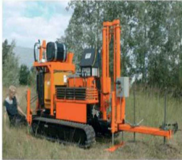
**Figure N°III-31 :Les essais pressiométriques**
