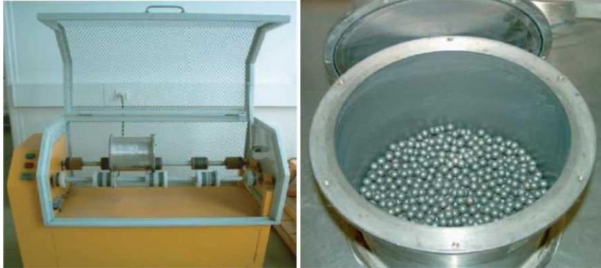
Figure N°III-30 : Essai Micro Deval
