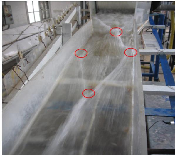
FIGURE 3.12 – La propagation de l'onde transversale  $Q_4 = 15,1$  L/s,  $\alpha = 5^\circ$  et  $\beta = 45^\circ$ .
