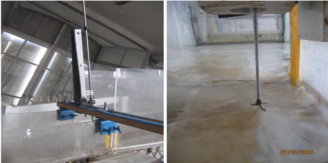
FIGURE 2.2 – Un limnimètre à gauche et un micro-mollinets à droite.
