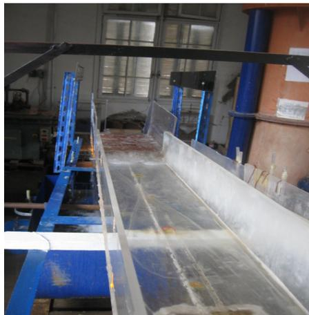
FIGURE 3.7 – L'onde de retour à la fin du canal principal, pour  $Q_2 = 2,1$  L/s et  $\beta = 22,5^\circ$
