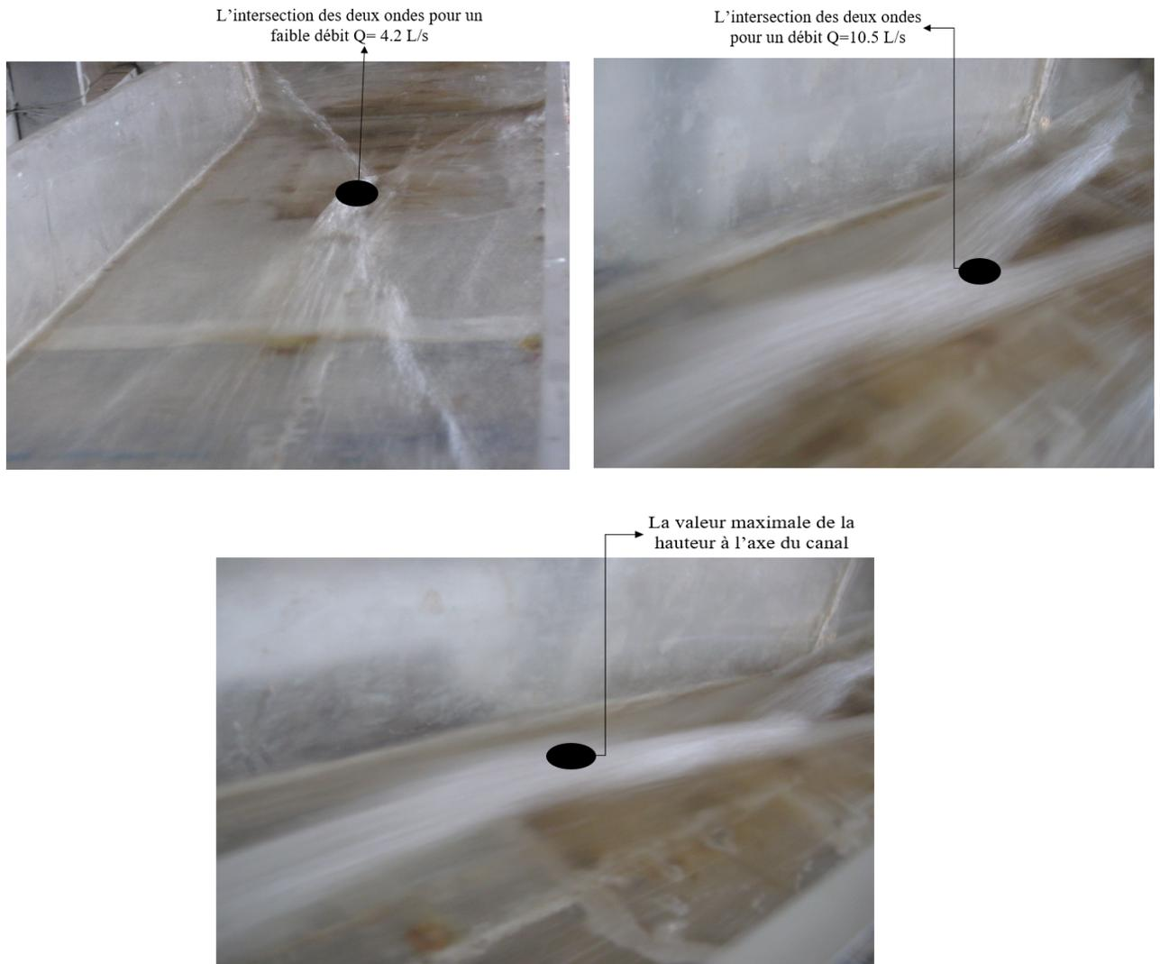
FIGURE 2.7 – Photos qui montrent, l'intersection des deux ondes transversales dans le convergent pour un faible débit, l'intersection des deux ondes transversales pour un débit moyen et le début de la formation d'un jet et sa valeur maximale.
