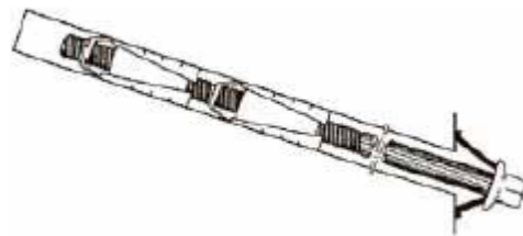
Figure IV.1 : Boulon à ancrage ponctuel
