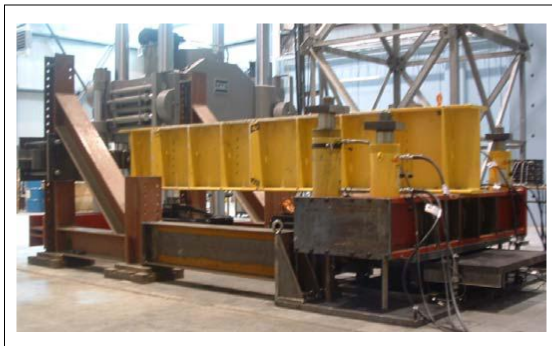
figure II.4.b : Montage d'essai sur les isolateurs sismiques [16]
