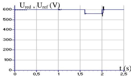
Fig.III.6.a. Tension de sortie du redresseur MLI
