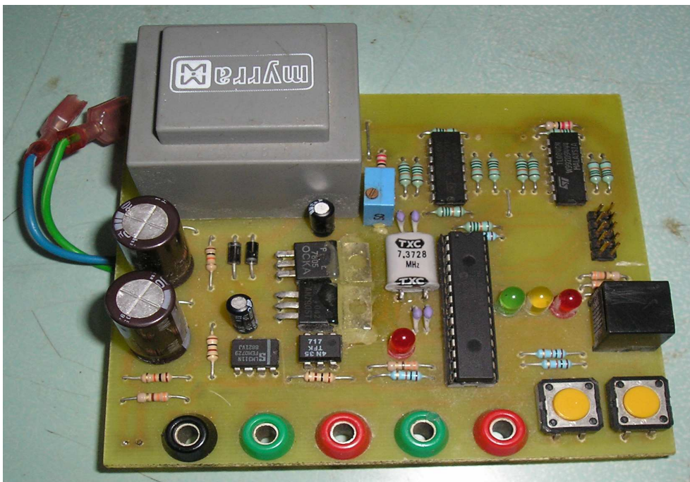
FIG. A.6 – Carte de commande du filtre actif à base du dsPIC30F2010
