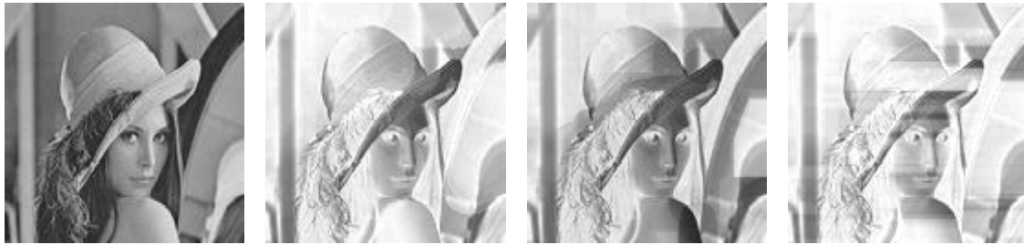
Figure 4.10: De gauche à droite : image initiale à plusieurs niveaux de gris, chapeau haut de forme blanc avec un disque de rayon = 15 pixels, chapeau haut de forme blanc un carré de taille = 15x15 pixels, chapeau haut de forme blanc avec un segment 15x1 pixels.
