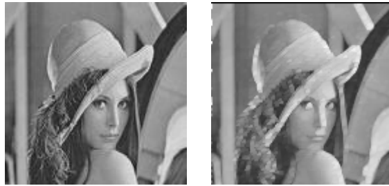
Figure 2. 5 : Exemple de filtrage médian. De gauche à droite : image initiale, filtrage médian (3x3).
