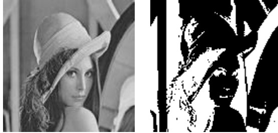
Figure 2.7 : Seuillage classique ( S=120 ). De gauche à droite : image initiale, image seuillée
