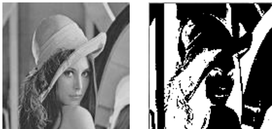
Figure 2.8 : Seuillage par hystérésis ( S_1=120 ; S_2=60 ). De gauche à droite : image initiale, image seuillée.
