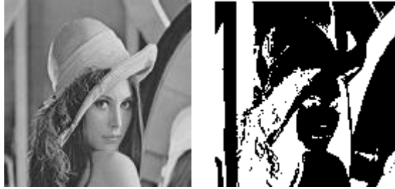
Figure 2. 9 : Binarisation automatique d'Otsu. De gauche à droite : image initiale, image seuillée
