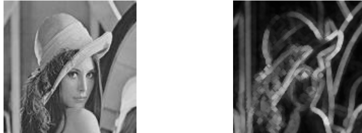
Figure 4.9 : à gauche image originale, à droite gradient associé à l'image (élément structurant disque de rayon = 2 pixels).
