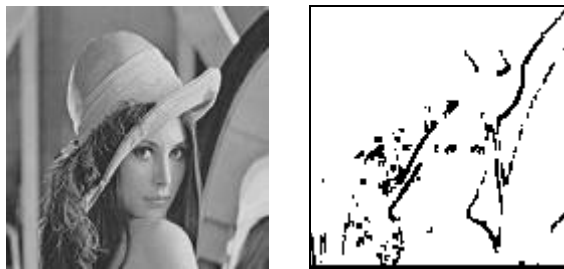
Figure 2. 10 : Binarisation automatique de Bernsen. De gauche à droite : image initiale, image seuillée
