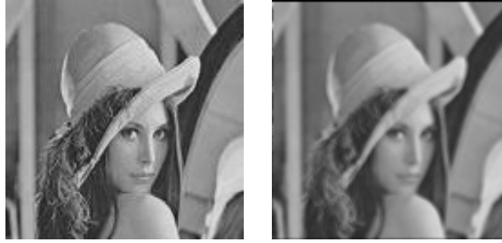
Figure 2. 2 : filtrage moyen 3x3. De gauche à droite : image initiale, image filtrée.
