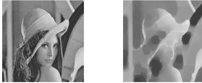
Figure 4.8 : Exemple de fermeture avec un disque de rayon = 5 pixels sur une image à plusieurs niveaux de gris.
