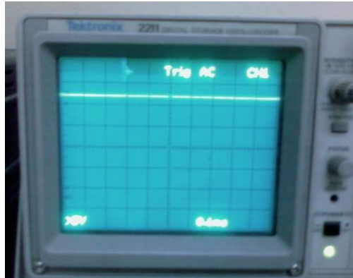
Figure 4.26: Sortie du capteur de tension.
