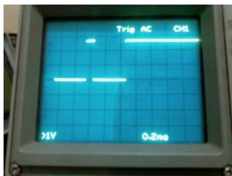
Figure 4.38: L'entrée série de l'UART en envoyant une valeur de '8'.
