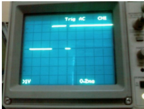
Figure 4.39: L'entrée série de l'UART en envoyant une valeur de '112'.
