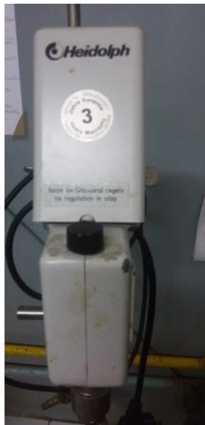
B) Agitateur mécanique de marque Heidolph
