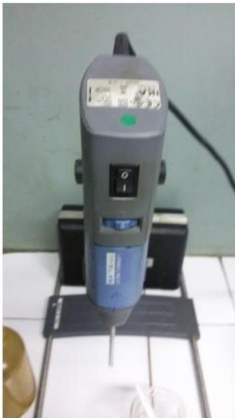
A) Homogénéiseur IKA T10
