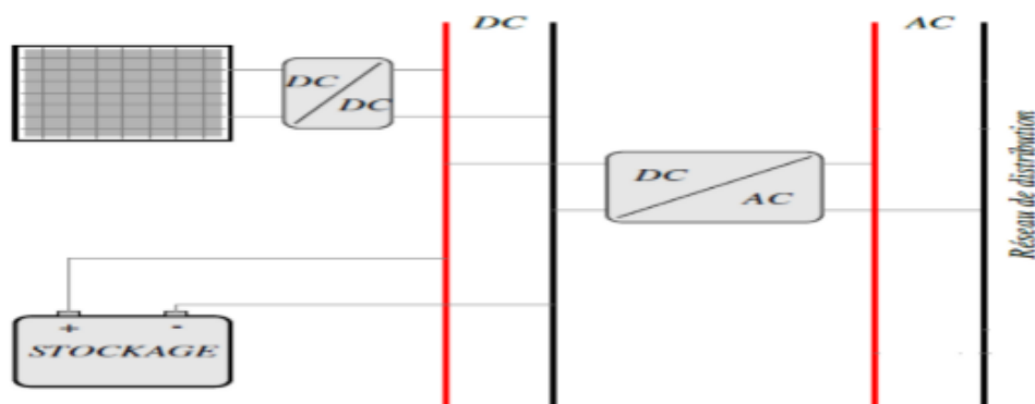
Figure I.19 – Installation photovoltaïque reliée au réseau avec batterie [14]
