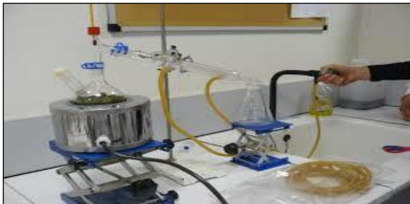
Figure 2.2 : Installation d'hydrodistillation [Site Web 7]
