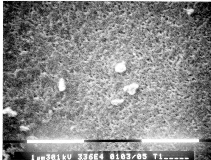
**Fig. III.4** Photographie d'une surface poreuse pour un substrat de résistivité 100  $\Omega$ .cm
