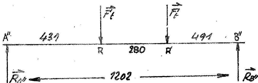
Détermination des réactions  $\bar{R}_A''$  et  $\bar{R}_B''$
